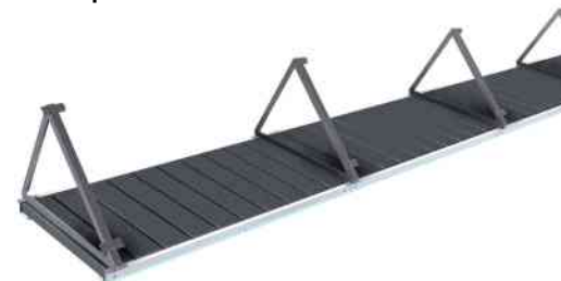
Pro Reihe wurden zwei Lastaufnahmeschienen verlegt, darauf werden die Ständer für die Kollektoren eingeklickt. Als Nächstes wird die Anlage mit Betonsteinen beschwert.
